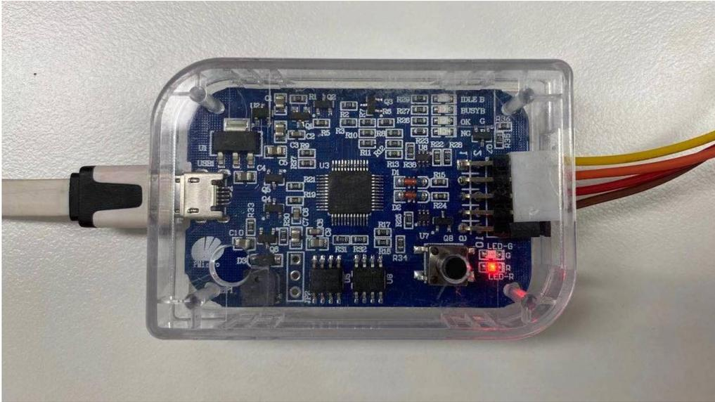
新版下载器，与电脑上位机连接采用 Micro USB 接口，使用常用的安卓充电线即可；
