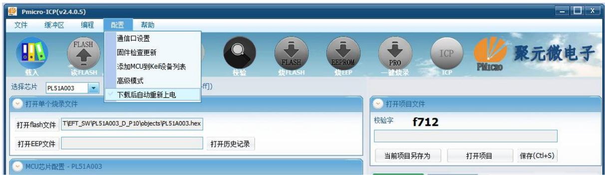
配置菜单中“下载后自动重新上电”功能，是指在用 ICP 对芯片一键烧录后实现给芯片重新上电，方便客户直接观察芯片运行效果。
